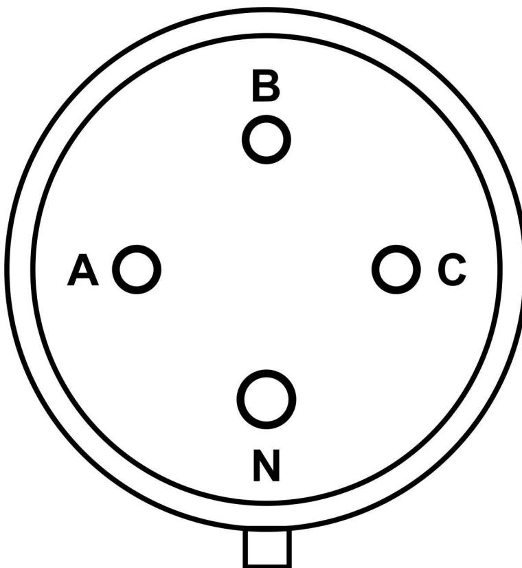
Підключіть мережеву розетку до трифазної мережі з робочим нулем N (нейтраллю) при цьому важливо дотриматись підключення нуля до контакту розетки N. Чергування фаз значення не має.
