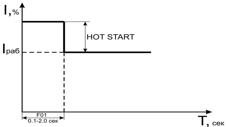
**2.5.1.2 «ФОРСАЖ»** - функція, що збільшує зварювальний струм при зменшенні дугового інтервалу, отже і напруги дуги (див. графік). При збільшенні струму форсажу збільшується глибина провару і ширина зварюальної ванни, а також запобігає злипанню електрода під час зварювання. Регулювання форсажу дозволяє збільшити зварювальний струм в режимах близьких до короткого замикання на значенні від 0 до 100 %.
